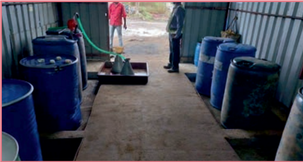
▲ നടപ്പാതയിൽ മുടിയ സ്ഥലത്ത് കളക്ഷൻ ട്രേകളിൽ സൂക്ഷിച്ചിരിക്കുന്ന അപകടകരമായ വസ്തുക്കൾ | പദ്ധതി സ്ഥലം: പാലക്കാട്, കേരളം
